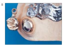
Modellguß und Sekundärkrone werden wie üblich fertiggestellt, wobei beim Modellguß der SD-PARACON-Stab nicht mitgeglänzt werden soll und beim Sekundärteil die Innenwandung der SD-PARACON-Hülse, falls nötig, mittels HM-Fräser Nr. 7505 versäubert wird.
