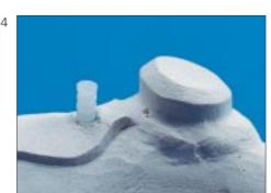
Der SD-PARACON-Stab sitzt nun lagerichtig positioniert im (Modellguß) Einbettmassemodell.
