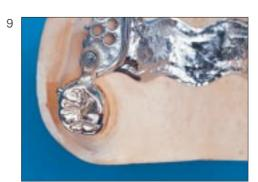
Modellguß und Sekundärkrone treffen nun erstmalig wieder aufeinander, wobei die SD-PARACON-Hülse der Modellgußretention angepaßt und ggfs. der Anschlag eingefräst werden muß (HM-Fräser **Nr. 7505**). Automatisch liegt bei diesem System eine Spielpassung vor, um einen spannungsfreien Sitz zu gewährleisten.
