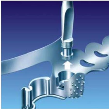
Nach dem Gießen kann der platzhaltende Gewindekern entfernt werden. Beim Glänzen sollte jedoch das Gewinde mit Wachs abgedeckt werden, um eine Beschädigung zu vermeiden. Arbeit wie gewohnt fertig stellen.
