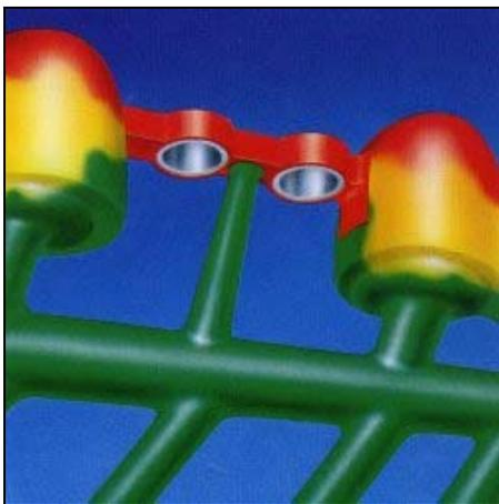
Die angewachsenen Matrizenteile werden mit Gusskanälen von 3mm Durchmesser versehen.
